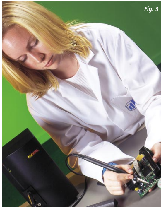
Fig. 2 e Fig. 3 - Saldatura manuale di componenti sensibili alla temperatura, con saldatore Metcal MX-500 SmartHeat e filo per saldatura lead-free Multicore Ecosol® TSC
