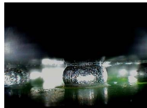
(BGA) Differenze nella forma della sfera, finitura superficiale, ed altezza distanziale
