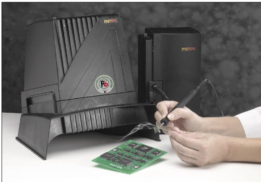
Sistema di estrazione fumi per postazione singola Metcal BVX-101
